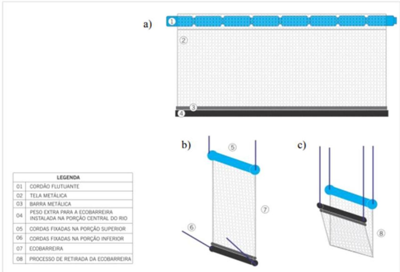
Figura 2: Ilustração esquemática da Ecobarreira. A) Vista frontal da ecobarreira mostrando a garrafas plásticas envoltas em tela metálica e as barras de ferro utilizadas para dar sustentação. B) Vista panorâmica demonstrando o processo de içamento da ecobarreira com destaque para as cordas superiores e inferiores. C) Vista panorâmica da ecobarreira ao ser içada em fechamento tipo envelope.
