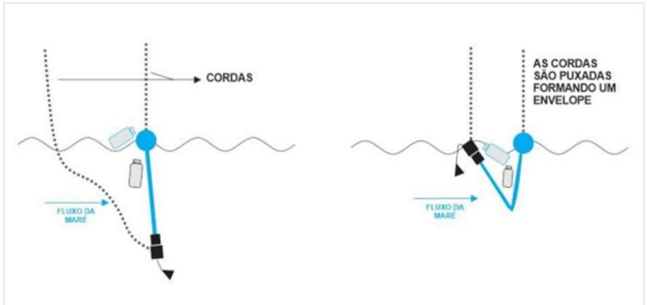
Figura 3: Esquema representando a coleta dos resíduos na ecobarreira.
