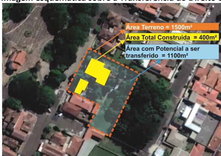
Figura 72: Imagem esquemática sobre a Transferência do Direito de Construir
